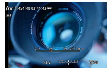
Abbildung 2.42 Das RF 35 mm f1,8 IS STM ist hier auf eine Entfernung von knapp 20 cm eingestellt, wie der kleine orangefarbene Strich in der Entfernungsskala anzeigt.
