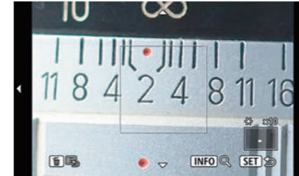
Abbildung 2.41 In der Suchervergrößerung können Sie am genauesten scharf stellen, sehen aber nicht mehr das ganze Bild.
