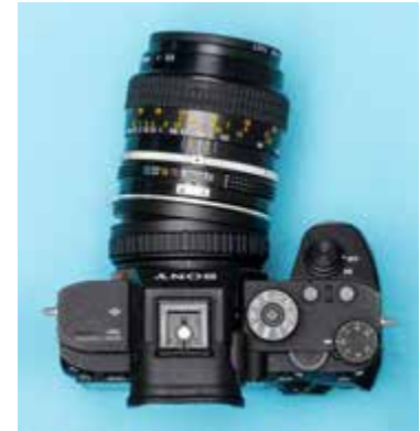
▲ Abbildung 3.40 Analoge Objektive lassen sich an spiegellosen Kameras mit Tilt-Adaptoren verwenden. Mit diesem Adapter lassen sich Nikon-Objektive bis zu 8° verschwenkt an einer Sony-E-Mount-Kamera verwenden.
