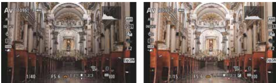
Abbildung 3.12 Links: Die Belichtungskorrektur im Einsatz. Bei einer »korrekten« Belichtung ist der untere Balken exakt über dem oberen spitzen Balken in der Mitte, was dem Wert 0 entspricht. Rechts: Hier wurde die Belichtung um den Wert +1/3 erhöht, wodurch das Gesamtbild wesentlich heller gemacht wurde.
