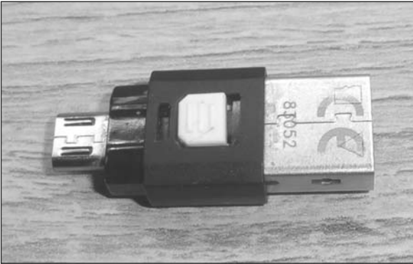
Abbildung 1.4: Dies ist sowohl ein Kartenschreiber als auch ein USB-Stick. Die MicroSD-Karte steckt rechts im USB-Stecker. Links der USB-Mini-Stecker wird OTG-Stecker (On-The-Go) genannt. Der weiße Schieber in der Bildmitte dient dem Auswurf der MicroSD-Karte.
