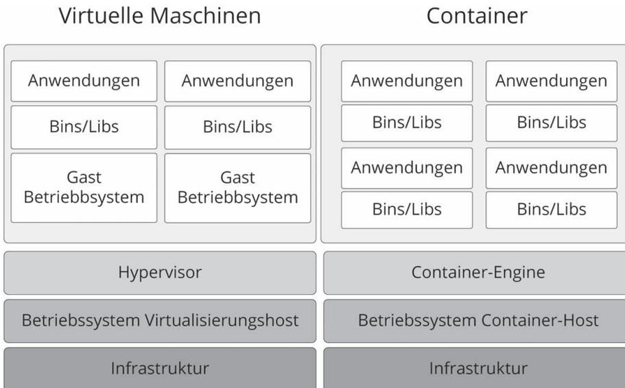
**Abbildung 1.2:** Vergleich zwischen virtuellen Maschinen und Containern
