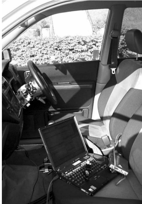
Abb. 1–3 Eine Testschnittstelle ermöglicht während der Fahrt, Interna der Steuergeräte-Software per Laptop zu überwachen. Die Testfälle sind in diesem Testfahrzeug per Definition real. Ihr Design ist aber im Vergleich zur Simulation eingeschränkter, zum Beispiel weil Unfallszenarien nicht einfach zu durchlaufen sind.
