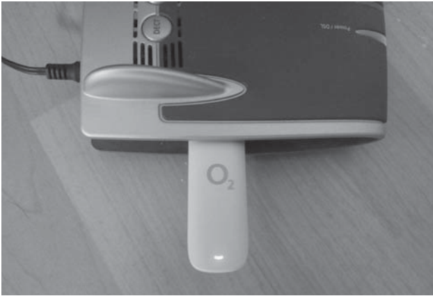
Abbildung 1.10: Wenn kein DSL zur Verfügung steht oder Sie sich vertraglich nicht binden wollen: Surfen mit dem UMTS-Surfstick
