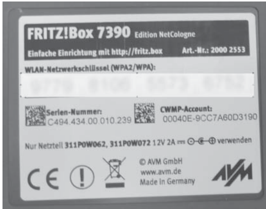
Abbildung 1.13: Der WLAN-Schlüssel auf dem Typenschild der Box
