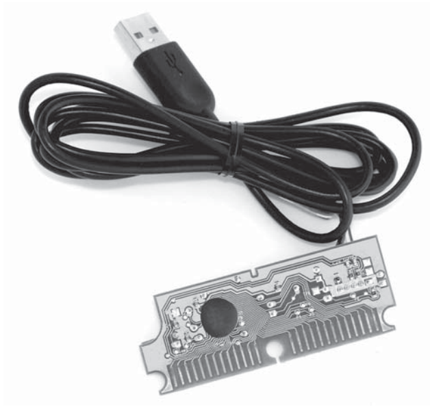
Abbildung 1.4: Die Innereien einer USB-Tastatur
