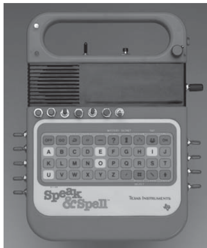
Abbildung 1.5: Ein vom Modified Toy Orchestra modifizierter Speak & Spell nach dem Circuit Bending (mit freundlicher Genehmigung von Modified Toy Orchestra)
